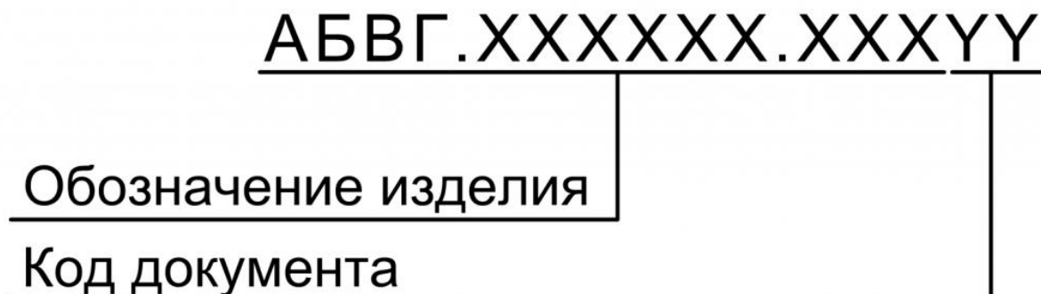
Рисунок 3 – Обозначение неосновного конструкторского документа
